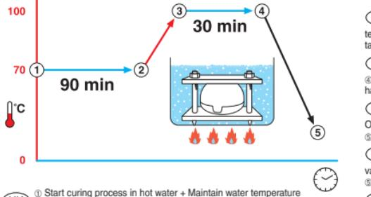
**MT** ① Ibda l-process tal-kura fl-ilma shun + Zomm it-temperatura ta'l-ilma stabbl ② Zid it-temperatura ta'l-ilma ③ Ibda l-process tal-kura + Zomm it-temperatura ta'l-ilma stabbl ④ Waqqil il-kura + Halli jiksah sat-temperatura tal-madwar ⑤ Tmiem tal-process tal-kura totali
